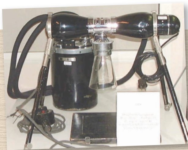
Draagbaar röntgenapparaat, de Metalix junior, van Philips uit 1928. | Bron: Philips
