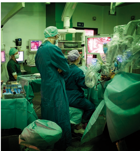
De Da Vinci-robot in actie: de apparatuur is in de patiënt ingebracht, alle onderdelen zijn steriel afgedekt; de operateur zit opzij, geheel apart, aan de bedieningsconsole.
