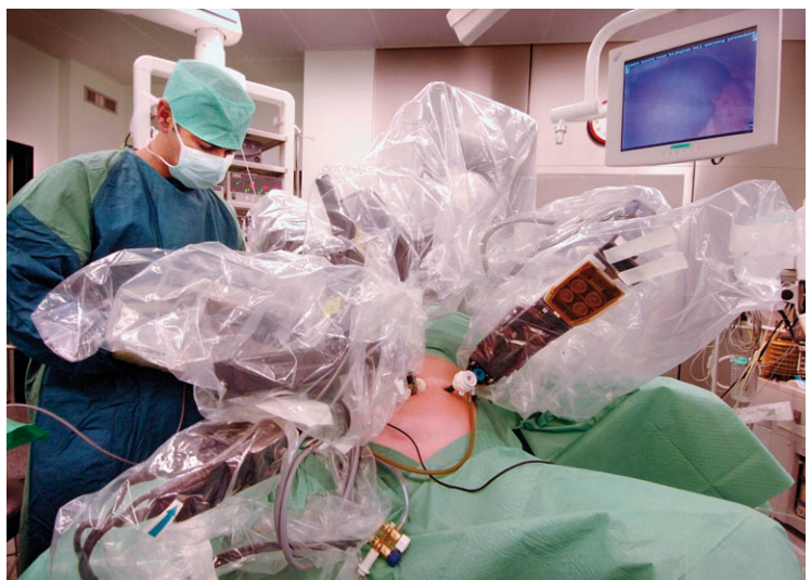
De Da Vinci-robot in actie: de apparatuur is in de patiënt ingebracht, alle onderdelen zijn steriel afgedekt; de operateur zit opzij, geheel apart, aan de bedieningsconsole.
